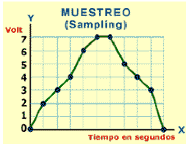
Fig 23: Para realizar el muestreo (sampling) de una señal eléctrica analógica y convertirla después en digital, el primer paso consiste en tomar valores discretos de tensión o voltaje a intervalos regulares en diferentes puntos de la onda sinusoidal.
