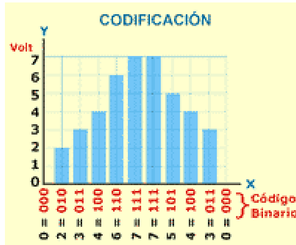
Fig 25: La codificación permite asignarle valores numéricos binarios equivalentes a los valores de tensiones o voltajes que conforman la señal eléctrica analógica original.
