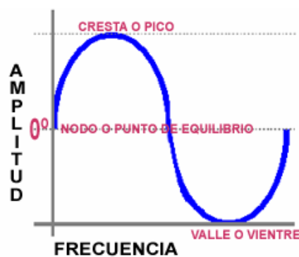
Fig. 2: Amplitud de una onda sinusoidal.
