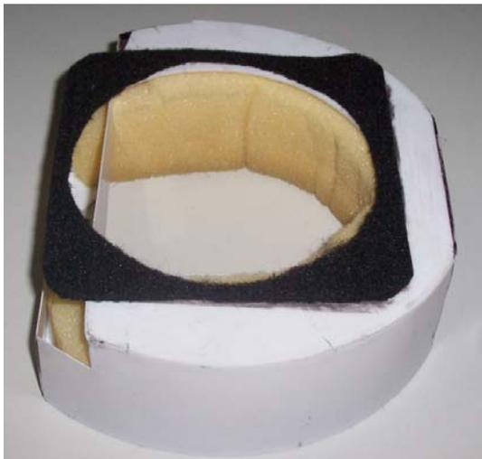
Imagen 4. Silenciador de descarga con espuma de poliuretano.
