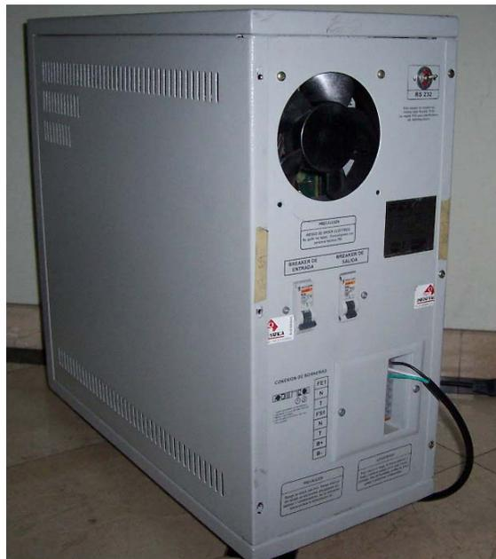
Sistema de refrigeración conformado por un ventilador de tipo axial ubicado en la parte posterior de la UPS (sistema de alimentaron continua).
