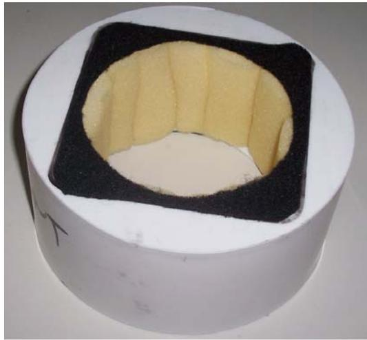
Imagen 3. Silenciador de entrada con espuma de poliuretano.
