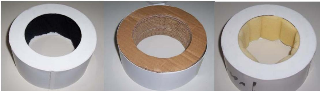
Imagen 2. Prototipos de Tela de algodón, Cartón corrugado, Espuma de Poliuretano. (de izquierda a derecha).
