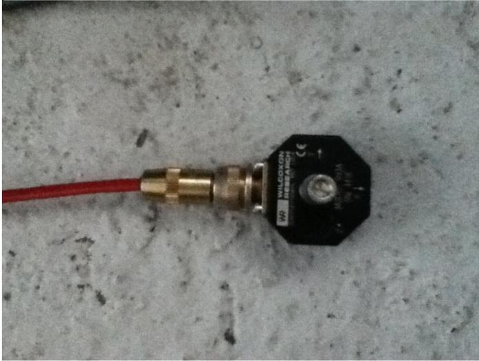
Figura 9. Ubicación Vibrómetro.
