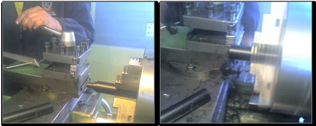
A cada uno de los martillos se les construyó una base cilíndrica en acero endurecido de 0,005m de altura con un diámetro de 0,30m, ya que la norma ISO 140-7<sup>14</sup>, pide que la superficie de impactos cumpla estas características; para instalarlos a los martillos, se procedió a perforar cada uno con una broca de 1/4", al igual que a cada una de las bases construidas. Se utilizó un tornillo brístol de 1/4", para unir las bases a cada martillo y asegurar que quedaran fijos al sistema.
