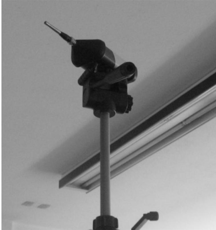
Una vez tomadas las mediciones se procedió a obtener los valores de ruido de impacto acorde con la norma ISO 140-7, estos datos obtenidos para cada posición de fuente y de micrófono se expresan como  $L_j$ , los cuales fueron promediados utilizando la siguiente ecuación:
