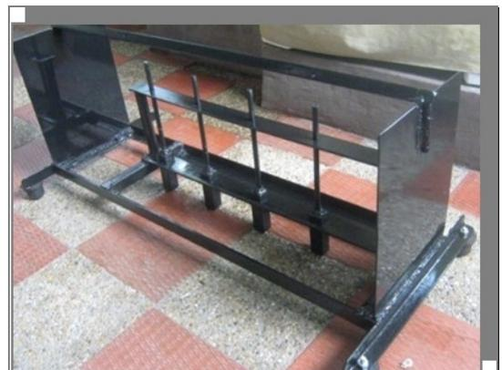
Luego se realizaron las perforaciones en la guía de los martillos, para ubicar las pestañas a través de las cuales, el sistema los levantará. (Fotos 35 y 36).
