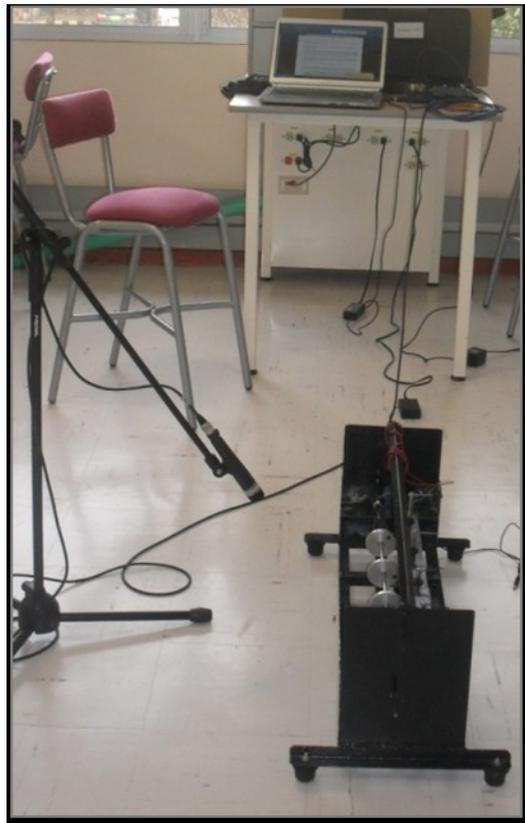
Con base en estas mediciones, se realizaron algunos ajustes a la máquina, modificando un poco el ángulo de los círculos que levantan los martillos, logrando así cumplir con el tiempo medio entre impactos, definido por la Norma ISO 140-7 de  $(100 \pm 20)$  ms. A continuación se puede ver esta comprobación siguiendo el siguiente hipervínculo:
