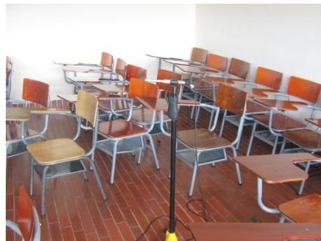
Se procedió a medir el tiempo de reverberación del salón receptor según la norma ISO 3382, los equipos utilizados fueron; como fuente un altavoz JBL EON 15, el micrófono de medición utilizado fue el ECM 8000 y una Consola Behringer EURORACK MX602A la cual recibía la señal del micrófono y la enviaba a un equipo portátil Sony Vaio, referencia VGN-NR210FH.
