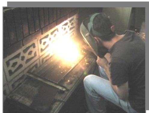
Posteriormente a esto, se cortaron y pulieron láminas de calibre N° 11 (*Foto 26*), para hacer las placas laterales de la máquina, de dimensiones de (0,20 x 0,28) m, las cuales se soldaron a la máquina (*Fotos 27 y 28*).
