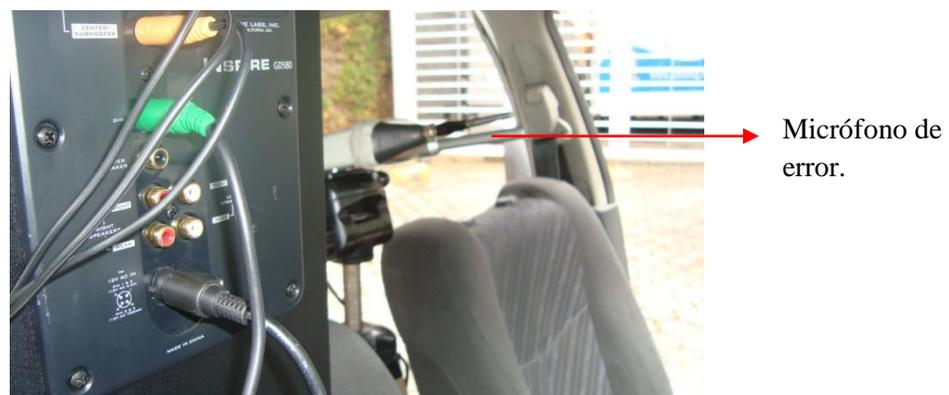
Cambiar la posición del micrófono de error, hace necesario estimar nuevamente la función de transferencia del camino secundario; esta tarea se realiza de igual manera que en la sección 5.6.1, para 450 y 750 coeficientes, como se muestra en la figura 60.
