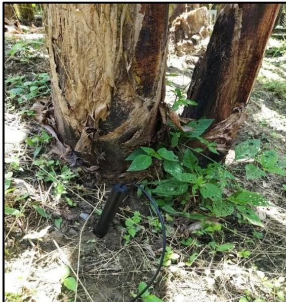
Fig. 22. Montaje del sensor SEN0249 in situ. Fuente: (Autores).
