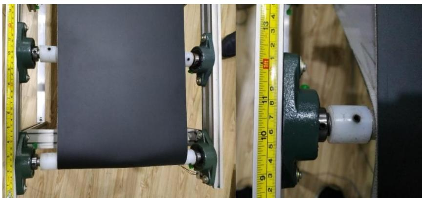
Figura 19. Punto de rodillo tensor en posición “Sin tensión”.
