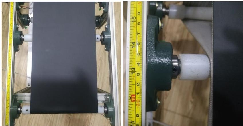
Figura 20. Punto de rodillo tensor en posición “Muy tensionado”.
