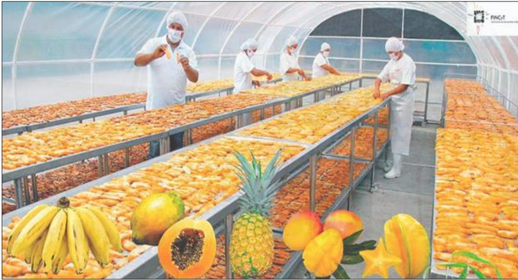
Ilustración 1 Empresa deshidratadora de frutas Chinchimayo Highland Coffee del Perú, deshidrata frutas con un método de secado solar por medio de bandejas de acero inoxidable omitiendo la utilización de químicos, gas o energía eléctrica “la imagen es tomada de (Portal turístico selva central, s.f.).
