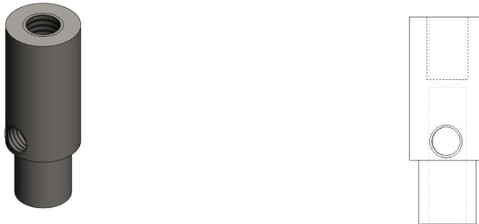
Entonces este acople cuenta con un orificio horizontal de 1/4 de diámetro, y en los dos extremos verticales cuenta con una rosca hembra en donde entra perfectamente el actuador, y en el otro extremo cuenta con una rosca macho y hueca para permitir la entrada del fluido al motor.
