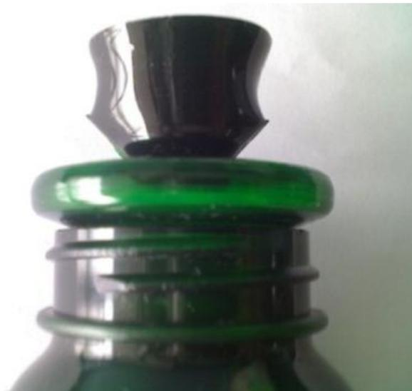
Según los moldes de formado de los frascos la rebaba tiene las mismas dimensiones para todos los frascos, es decir la rebaba del frasco de 60ml es igual al de 300 ml, por consiguiente la rebaba tiene las siguientes medidas:
