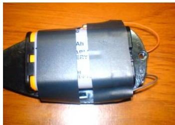
Foto 5 Vista de la batería en la parte posterior del circuito
