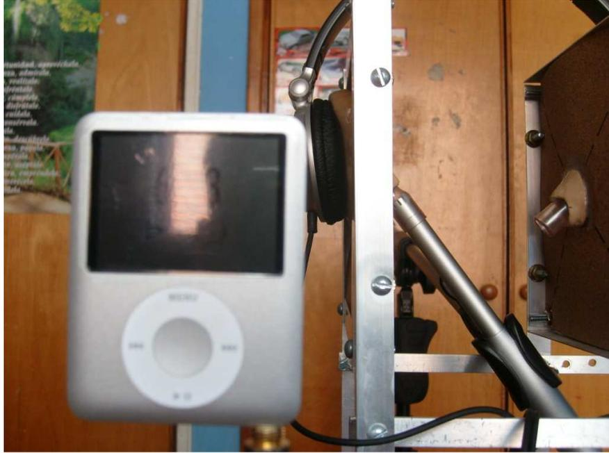
*Figura 31: Esquema de medición de nivel del auricular en el emulador.*
