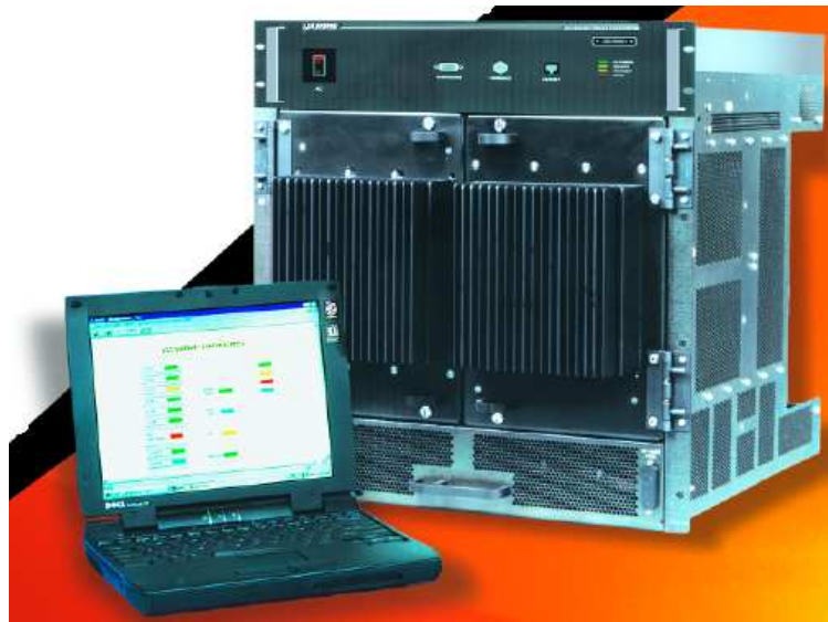
Figura 41 HGS y Laptop para mantenimiento
