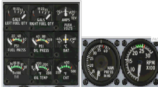
Figura1. Instrumentos de motor. Fuente: Microsoft Flight Simulator®.
