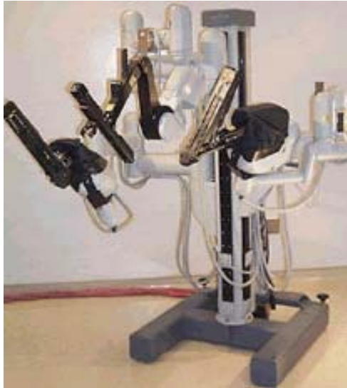
Figura 4. Brazo robótico compuesto de tres brazos sujetadores
