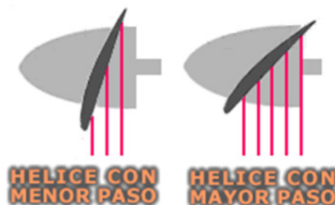
Imagen 5: Paso de la Hélice.[35]
