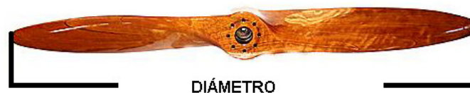
Imagen 4: Diámetro de la Hélice.[34]
