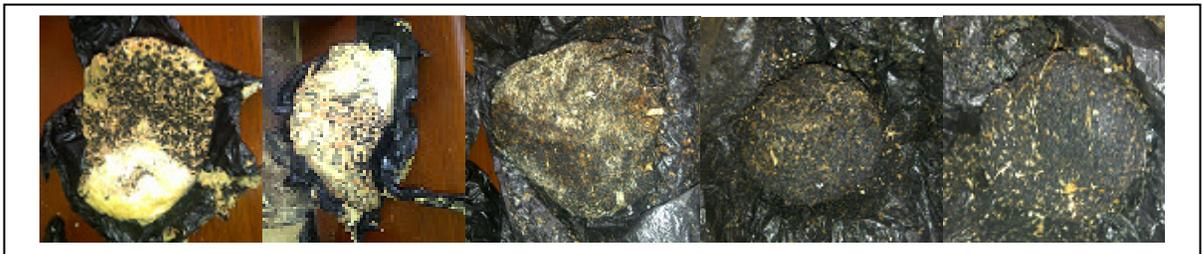
Figura 9. Muestras realizadas con adhesivo a base de solventes
