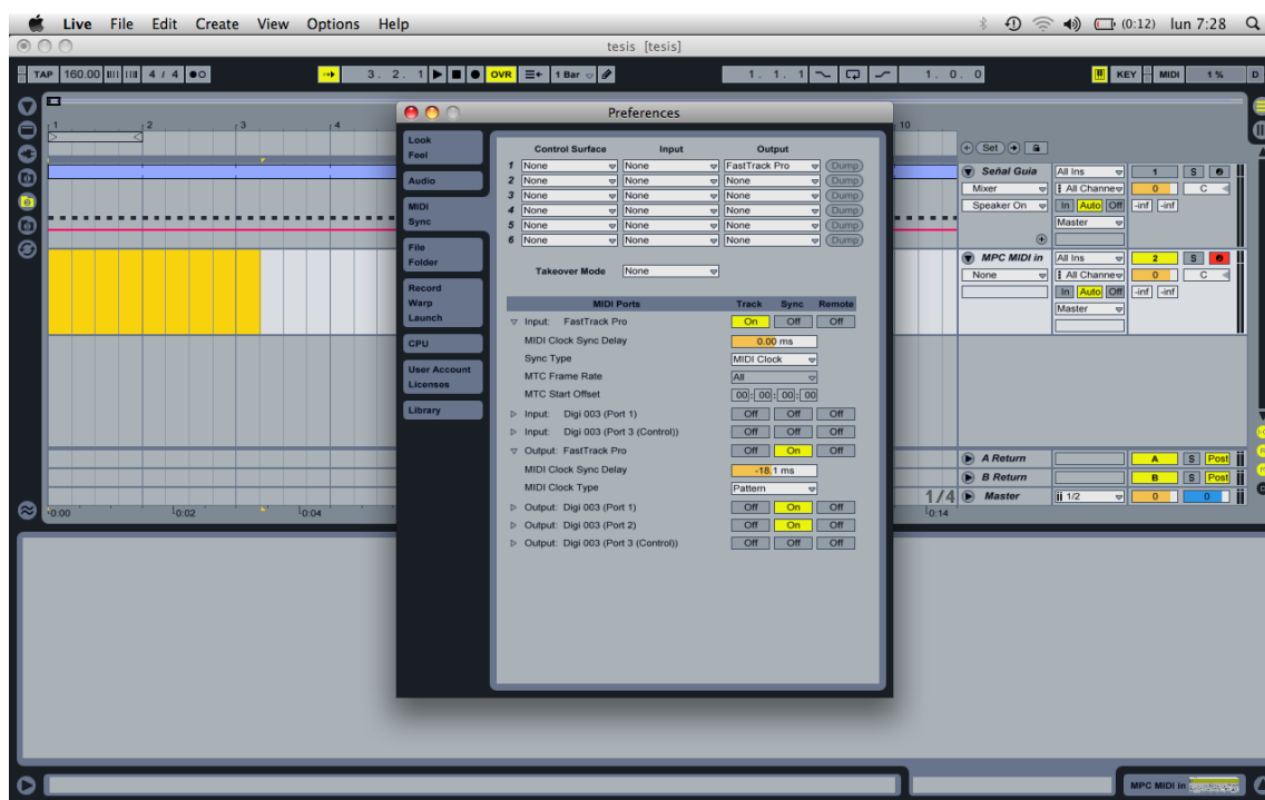
Fig. 31. Configuración retraso de reloj Ableton Live.
