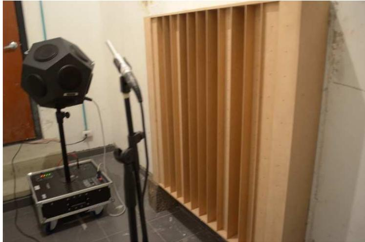
Figura 35. Medición de absorción del abfusor (posición de fuente2).
