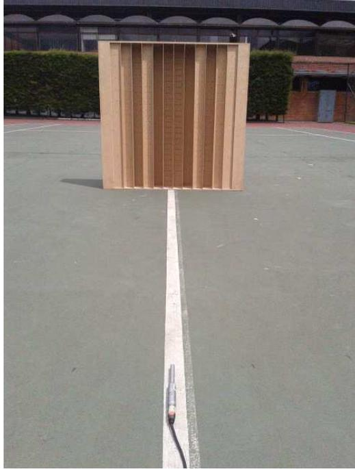
Figura 40. Medición de difusión del panel abfusor con receptor a (-55°).
