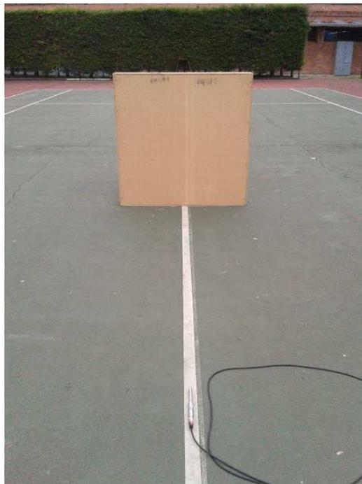
Figura 39. Medición de difusión del panel abfusor en la posición de referencia.
