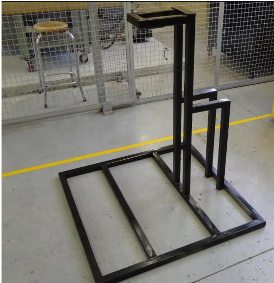
A la base se le aplico una primera capa de pintura especial para metales de color negro brillante para evitar la corrosión de sus componentes y dar un acabado mucho más fino.
