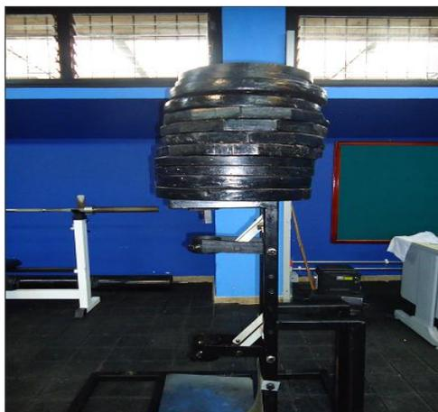
Teniendo una fuerza aplicada de 200 kgf sobre la estructura se aumenta el número de discos para completar 3000 N (300 kgf). Confirmando que la validación en ANSYS en el diseño preliminar es correcta obteniendo una estructura rígida y capaz de soportar esfuerzos para los cuales fue diseñada. Para ver los videos de esta prueba refiérase al anexo D.
