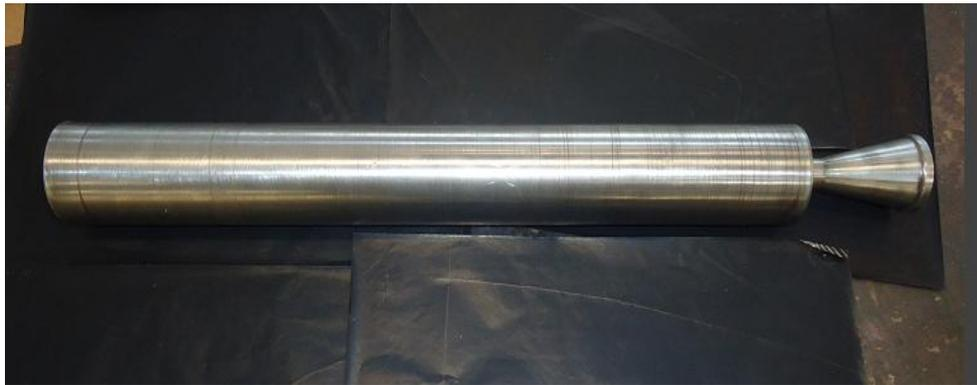
Para el correcto funcionamiento y seguridad del motor tipo k es necesario sellar la tapa y la tobera muy bien, para esto se contara con anillos tipo O u (O-rings) los cuales brindaran una un correcto sellado al motor
