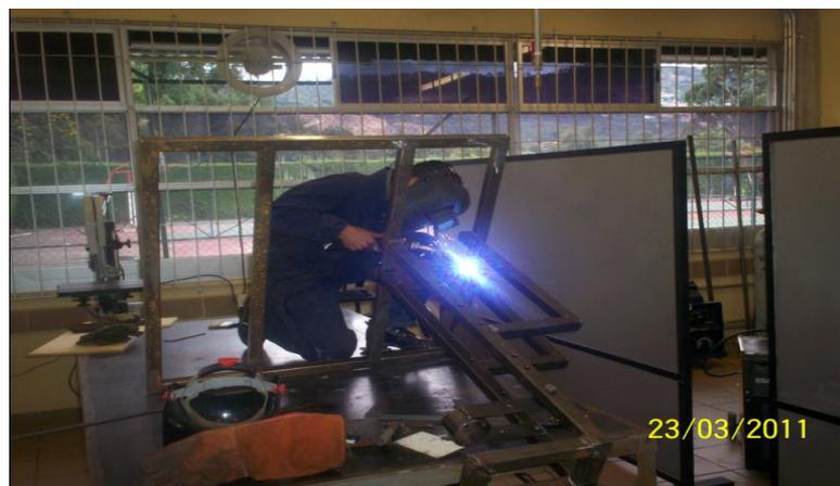
Cuando se construyó la base estructural del BEMCO, se encontró una alta vibración en la estructura, por lo que se decidió agregar dos soportes adicionales al diseño preliminar.
