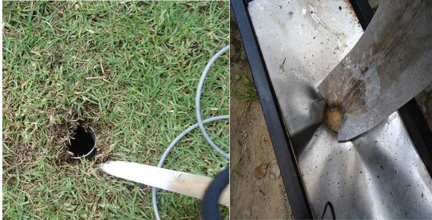
Desafortunadamente en esta prueba el motor cohete tipo K sufrió una expulsión de su tapa superior en la combustión, cambiando el curso de motor cohete, que a su vez perforo las laminas de acero inoxidable enterrándolo totalmente en el suelo.
