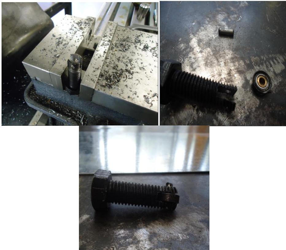
Con la misma fresadora se abrió un agujero de 5 mm utilizando una broca de 13/64, más adelante se compro una barra de acero plata de 5 mm de diámetro, fue cortada en pedazos de 1,5 cm para ser este el eje de rotación del rodamiento.
