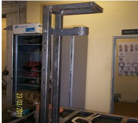
La tubería que va en posición vertical fue prensada en la fresadora para poder abrir los diferentes huecos del BEMCO, cada uno de estos huecos está distanciado del otro de acuerdo a la configuración de los diferentes motores cohete.
