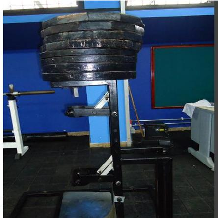
Sobre la estructura fueron puestos 8 discos de 55 lb cada uno como se muestra en la figura 75, demostrando la rigidez de la estructura del banco de ensayo para motores cohete.
