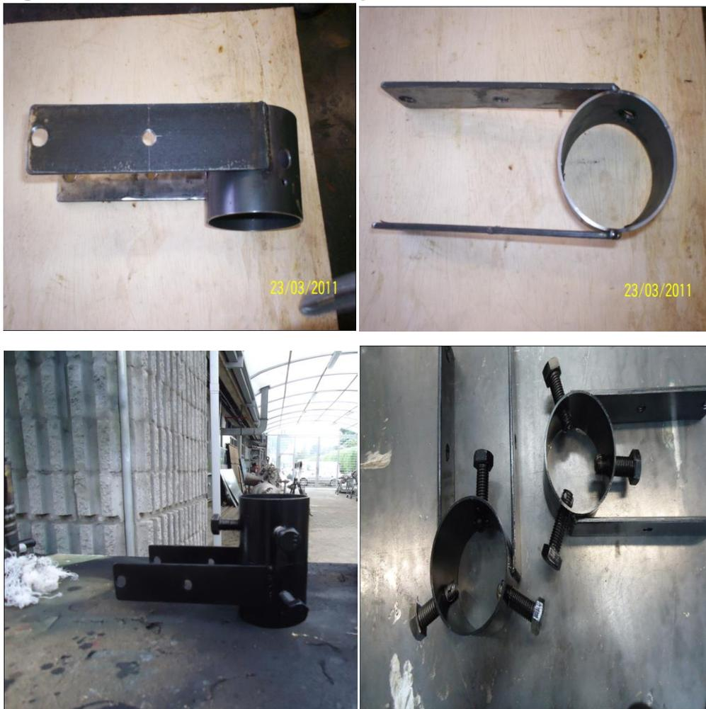
Posterior a los agujeros se soldaron los conectores perpendicularmente al cilindro, además fueron ensamblados los tonillos rodamiento dentro de los soportes y finalmente pintados con pintura espacial para metales color negro brillante.
