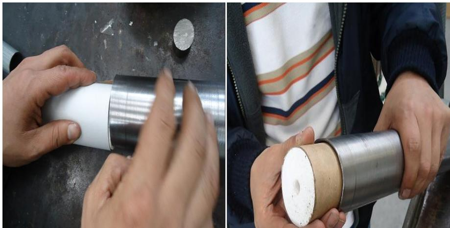
Para el llenado del motor k utilizaremos el propelente “candy “con nitrato de potasio y sorbitol.
