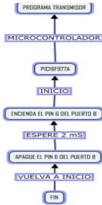
FIGURA 16. Diagrama de bloques de la programación para el transmisor.
