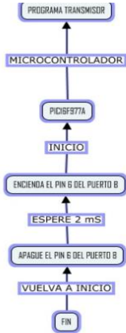
Figura 5. Diagrama de bloques programación Tx
