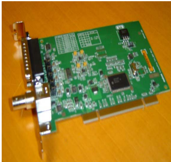
Figura 16. Tarjeta de control
