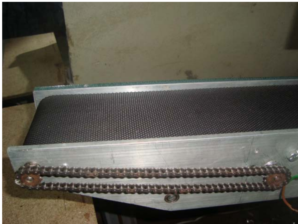
Figura 29. Sistema de desplazamiento horizontal
