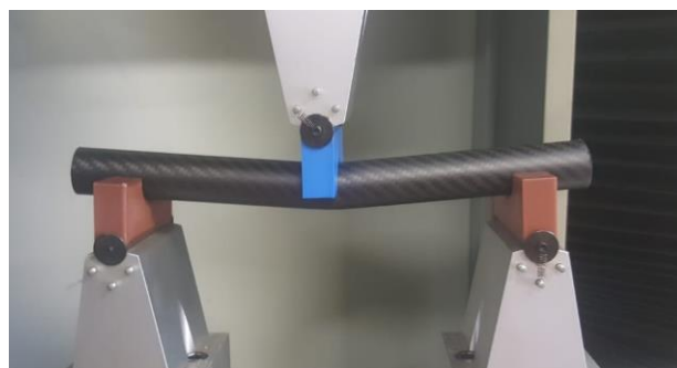
Figura 89. Deformación a flexión con piezas de impresión 3D
