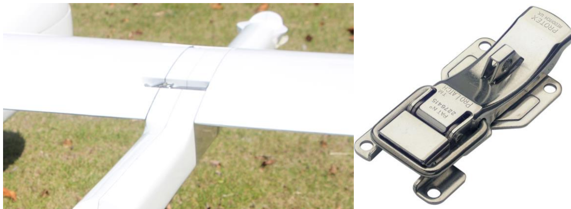
Figura 33. Unión de ala externa-interna por medio de un gancho
