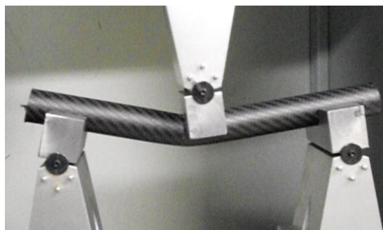
Figura 86. Deformación a flexión con aditamento de soporte de acero
