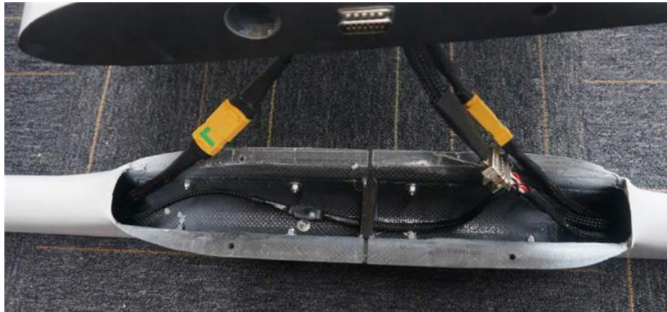
Figura 34. Unión Tailboom-ala de la aeronave Mugin
