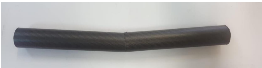
Figura 90. Falla a flexión con piezas de impresión 3D
