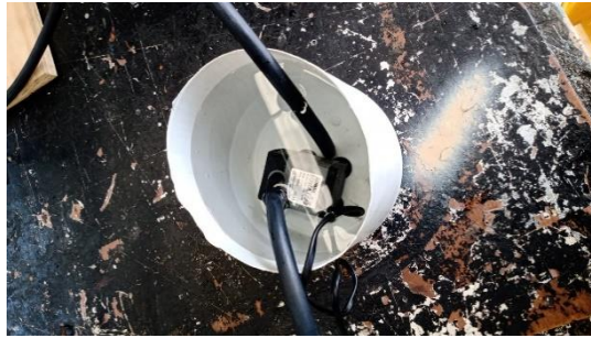
Fig. 39. Acople de mangueras con bomba.
