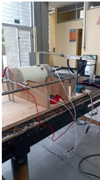
Fig. 24. Cámara Óhmica construida (Vista trasera).
