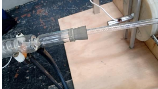
Fig. 37. Acople de codo con condensador refrigerante.
