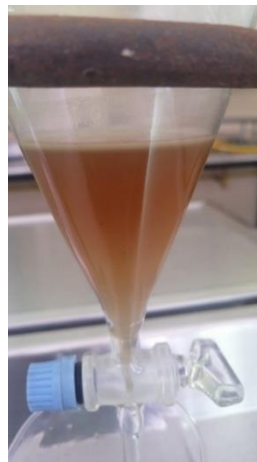
Fig. 45. Embudo de decantación con la mezcla aceite agua.
