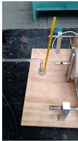
Fig. 36. Acople de termómetro y codo en tapón.
