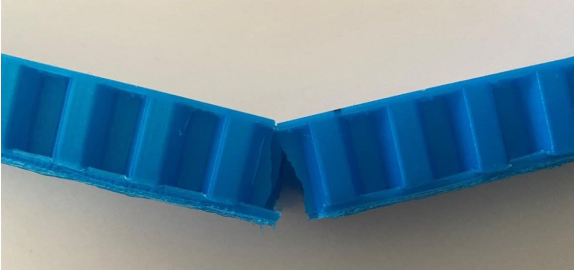
Figura 47. Probeta de 1/4" con tipo de falla M-A-B. Fuente: Autores.
