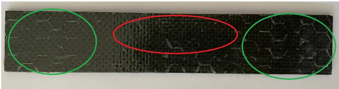
Figura 57. Zonas de adherencia profunda y superficial en los laminados. Fuente: Autores.
