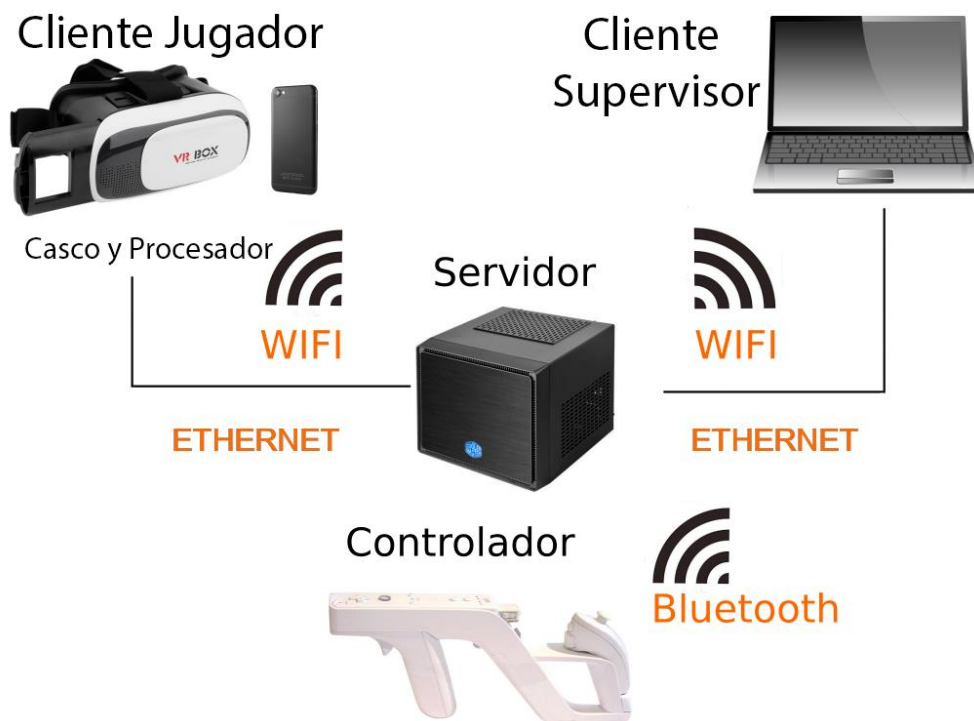
Figura 1. Diagrama general de arquitectura y componentes físicos del sistema VRIMP.
