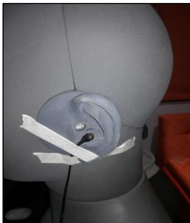
Figura 23. Ubicación de un micrófono DPA dentro de la oreja de la cabeza binaural.
