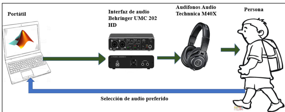
Figura 28. Diagrama de conexionado empleado para la realización de las pruebas de preferencia entre métodos de simulación de crosstalk.
