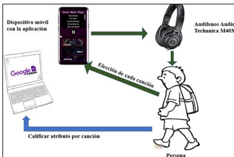
Figura 34. Diagrama de conexionado de la prueba de calidad sonora.
