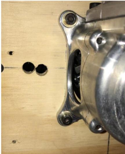
*Figura 16 Montaje del motor en bancada de pruebas por medio de junta pernada con utilización de arandelas.*
