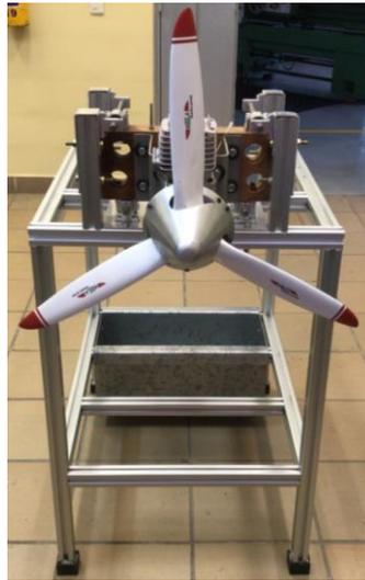
*Figura 28 Motor instalado para prueba de estructura.*
