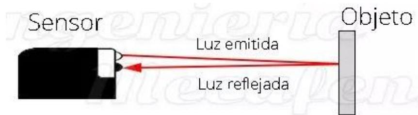
*Figura 7 Sensor Óptico Difusor-Reflectivo (Mecafenix, s.f.)*
