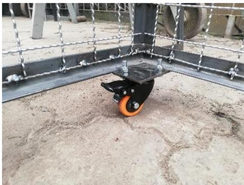
*Figura 47 Instalación de las ruedas*
