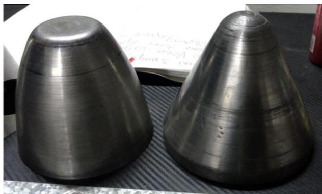
*Figura 21 Moldes para realización del spinner*
