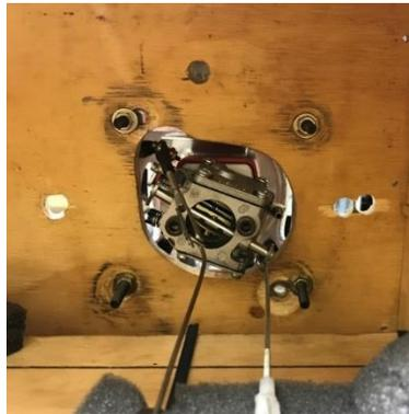
*Figura 15 Sujeción del motor a la bancada*
