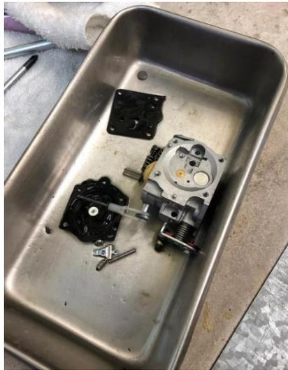
*Figura 27 Limpieza del carburador*
