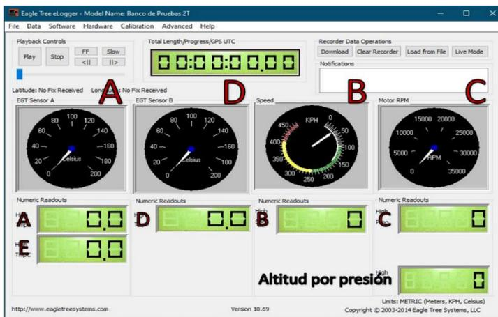
*Figura 37 Configuración del software Data Recorder*
