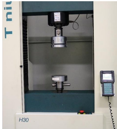
Figura 37. Disposición inicial de la prueba mecánica a compresión.
