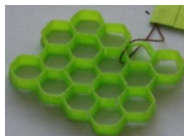
Tamaño de Celda: 3/8" Espesor Pared Celda: 0,4 mm
