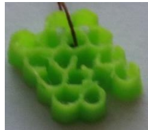
Tamaño de Celda: 5/32" Espesor Pared Celda: 0,4 mm
