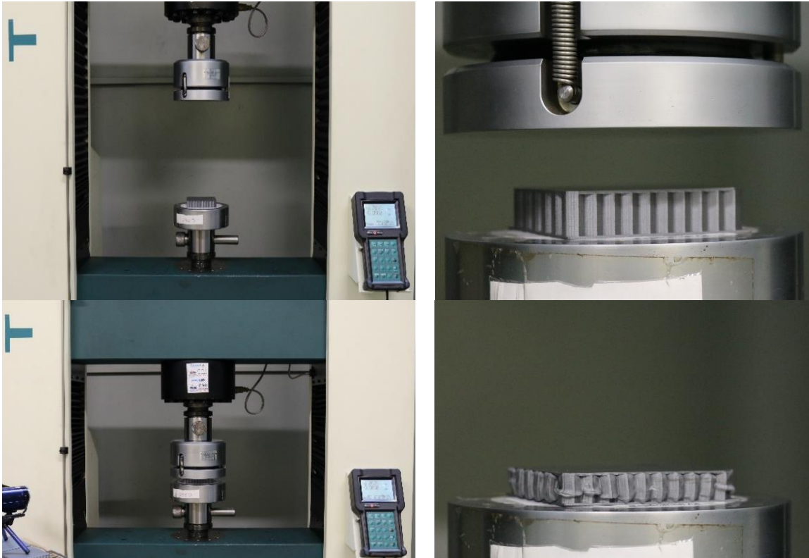
Figura 41. Prueba y posicionamiento del espécimen en máquina universal de ensayos Tinius Olsen H300KU. Fuente: (Autores, 2019).
