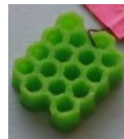
Tamaño de Celda: 3/16" Espesor Pared Celda: 0,8 mm
