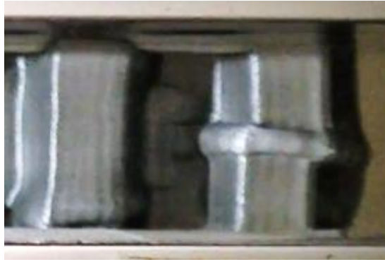
Figura 22. Deformación cortante de celda debido a falla por deposición de filamento seccionado.
