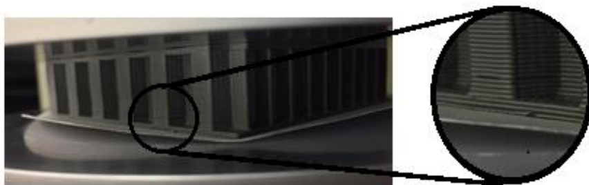
Figura 23. Ausencia de deposición de filamento en el espécimen.
