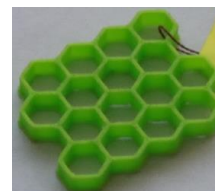
Tamaño de Celda: 3/8" Espesor Pared Celda: 0,8 mm
