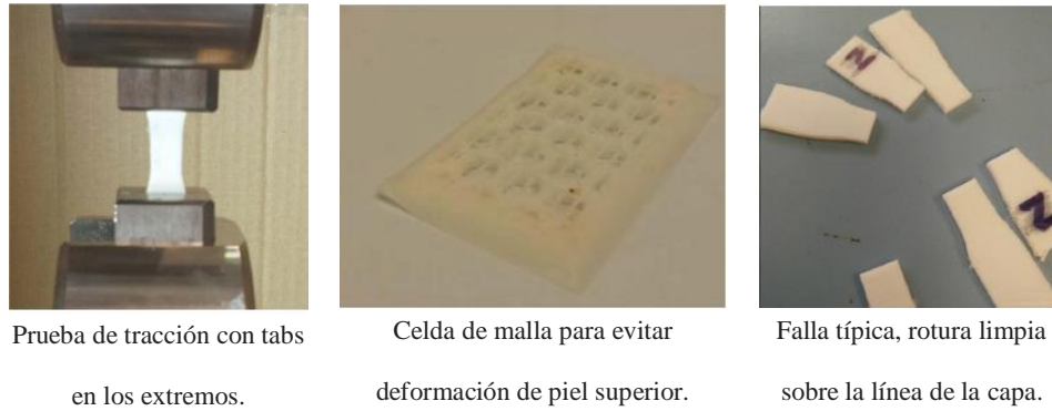
Figura 3. Espécimen antes y después de la prueba a tracción.
