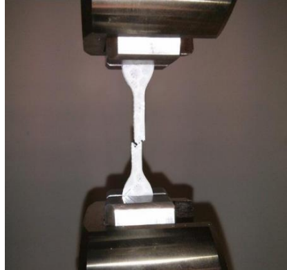
Figura 8. Caracterización de probetas de materiales PLA y ABS, ensayos destructivos.
