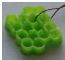
Tamaño de Celda: 3/16" Espesor Pared Celda: 0,4 mm
