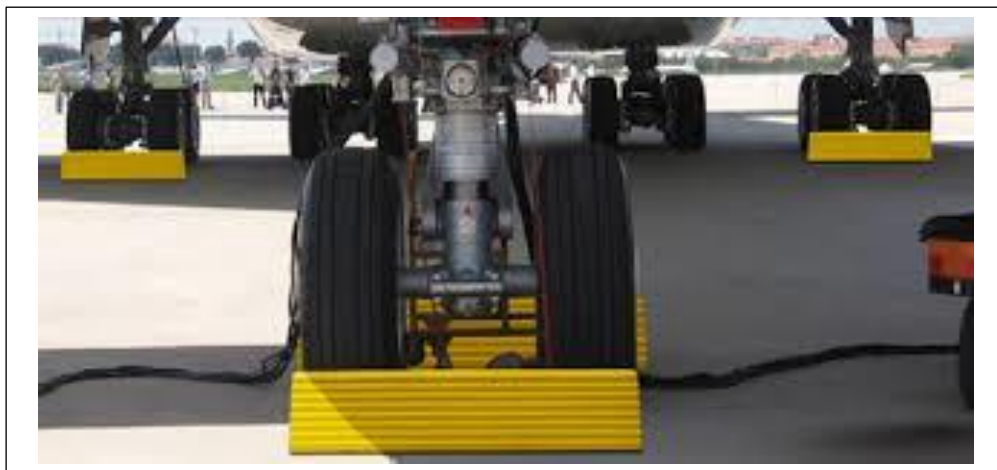
Ilustración 18: Tacos o Cuñas para el tren de la aeronave (Tomado de http://www.olaflex.com/tacos-para-aviones.html )
