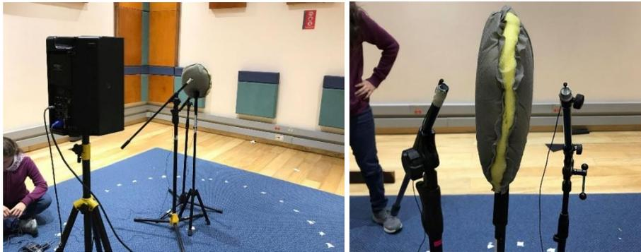
En el caso de la técnica Binaural no se hizo uso de una cabeza artificial, sino que se realizó el posicionamiento de los dos micrófonos 4060 junto a los pabellones auditivos del sujeto cumpliendo con el estándar usado de 1.50 metros con respecto al suelo como se puede observar en la figura 4-1-6, la diferenciación entre ambos lados de la cabeza se mantuvo con respecto a las dos primeras técnicas utilizadas.
