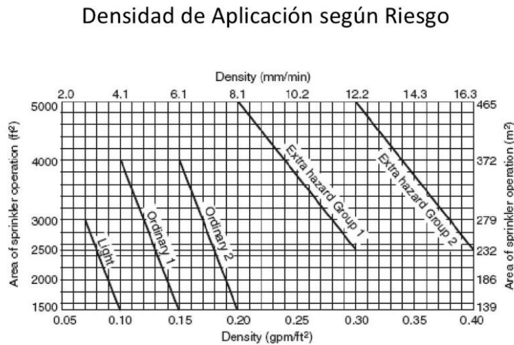
Figura 15. Densidad vs Área de operación. Fuente: NFPA 13. (2013)
