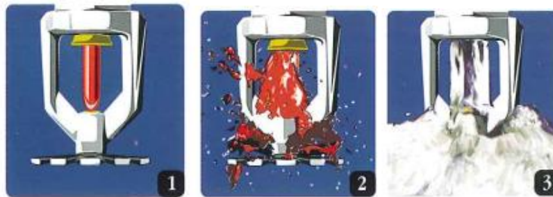
Figura 2. Funcionamiento rociadores automáticos. Fuente: Tecnifuego. (2018)
