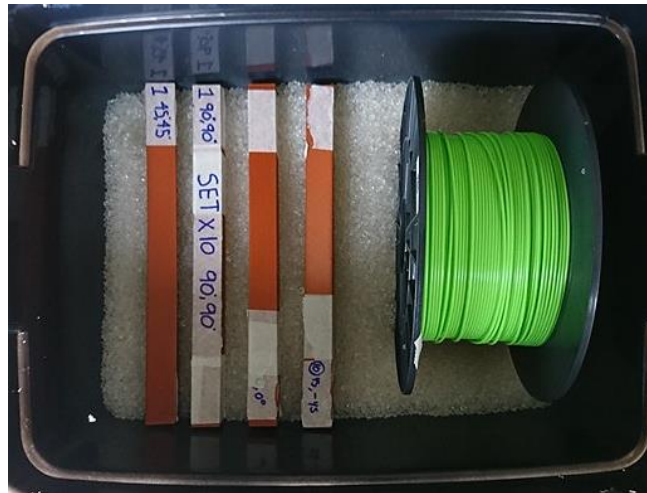
Figura 15. Caja de almacenamiento de carretes de material y probetas.
