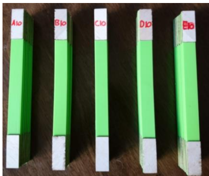
Figura 34. 5 lotes de PLA con tabs instalados.
