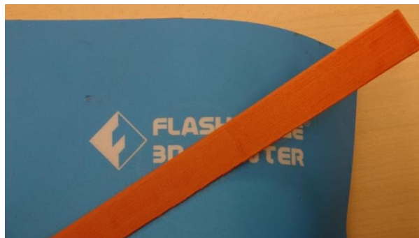
Figura 27. Proceso de desmolde de la probeta sobre la cama magnética.
