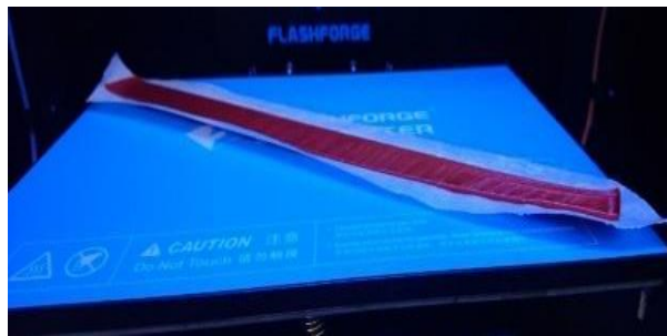
Figura 22. Error de pandeo en la probeta.
