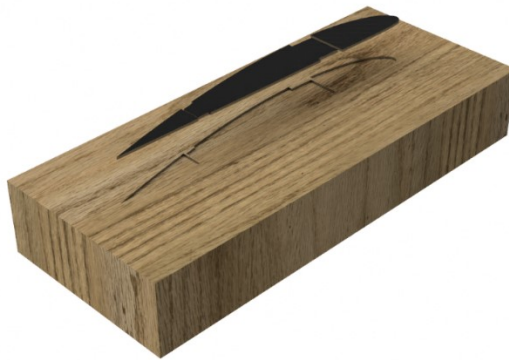
Figura 93 Molde y laminado de las costillas
