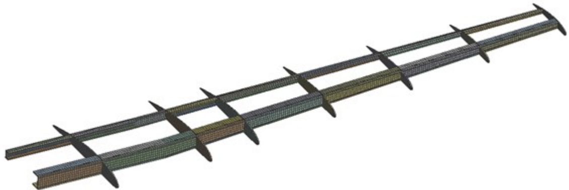
Figura 39 Enmallado costillas y vigas alerones
