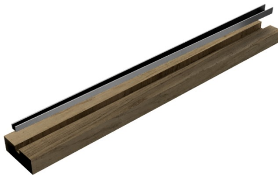
Figura 95 Molde y laminado viga taperada
