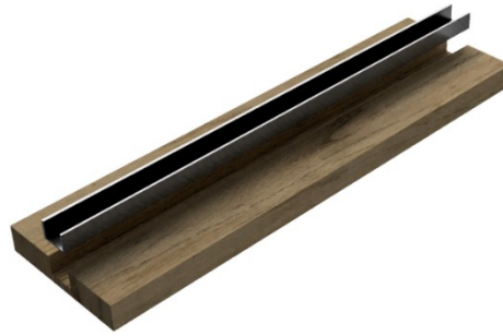
Figura 94 Molde y laminado de viga central
