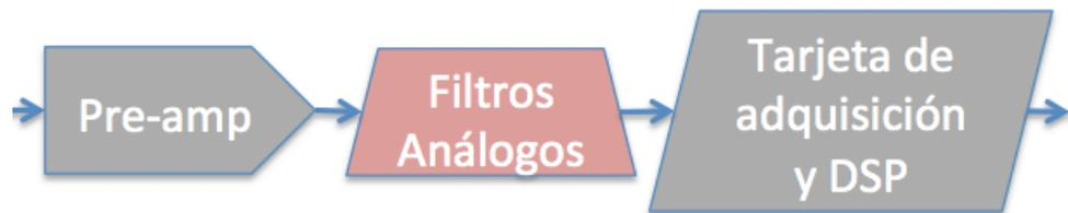
Figura 18. Sección de Filtros Análogos dentro del diagrama general. Fuente: Propia.
