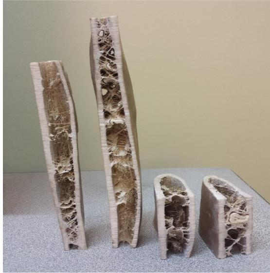
Figura 13. Probetas ensayos de compresión y flexión, vista lateral.
