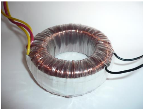
Figura 24 Transformador toroide de 12, 0, 12 voltios
