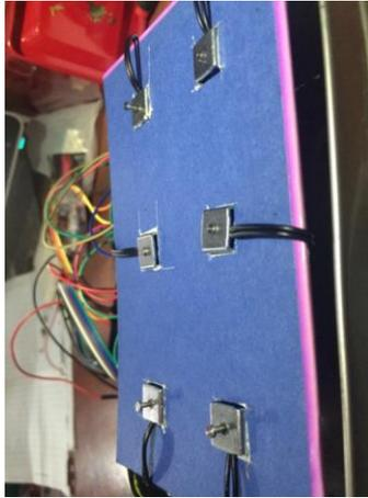
*Figura 40.* Representación de la letra “U” en el sistema braille por medio de pistones.
