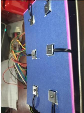
*Figura 36.* Representación de la letra “A” en el sistema braille por medio de pistones.
