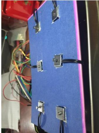
*Figura 39.* Representación de la letra “O” en el sistema braille por medio de pistones.
