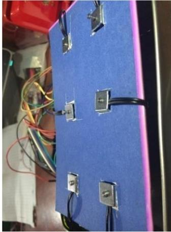
*Figura 38.* Representación de la letra “T” en el sistema braille por medio de pistones.
