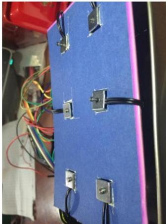
*Figura 37.* Representación de la letra “E” en el sistema braille por medio de pistones.
