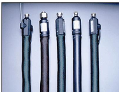
Figura 10 Acoples para máquina de hotmelt<sup>14</sup>
