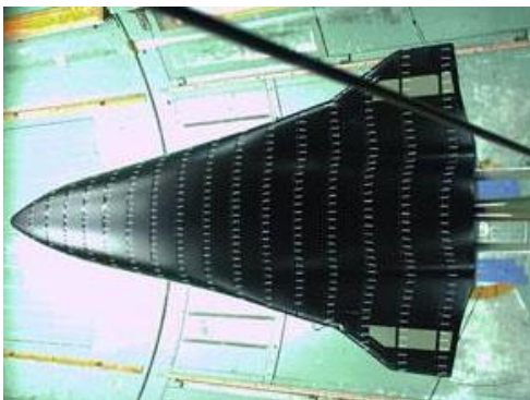
Figura 1. (Montaje de los tufts sobre una superficie)
