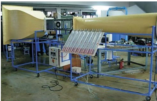
Figura 25 Montaje de un multimanómetro en un túnel de viento Fuente: http://www.indiamart.com/swargsysteminstruments/fluid-mechanics-hydraulic-machines.html
