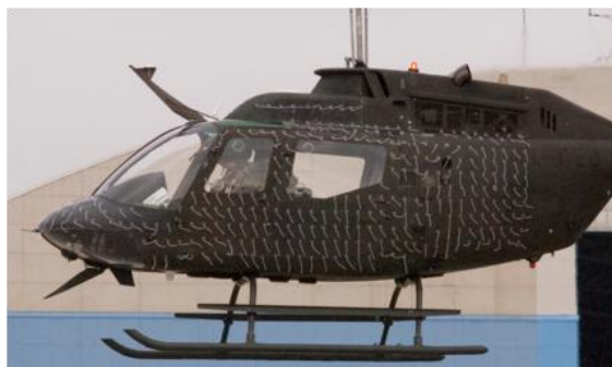
Figura 44. Visualización por tufts helicóptero Fuente: http://rotorcraft.arc.nasa.gov/Research/Programs/brownout.html
