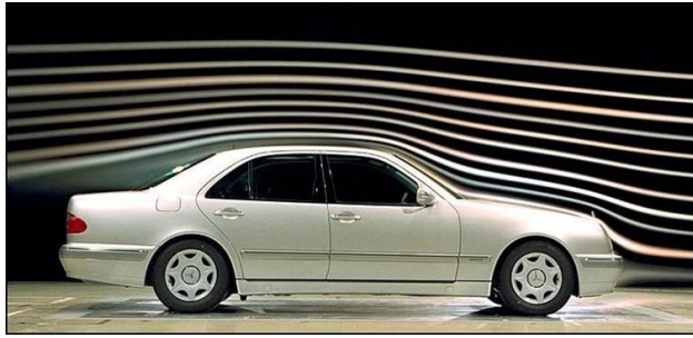
Figura 43. Sistema de inyección de humo Mercedes Fuente: http://feature.mpi-inf.mpg.de/2012/characteristiccurves
