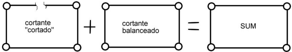
Figura 49 Sumatoria de flujos cortantes.
