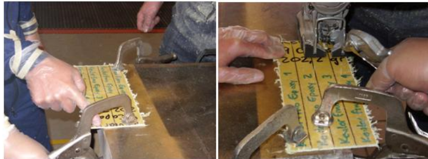
Figura 58 Corte de probetas; fuente: grupo AEROTECH
