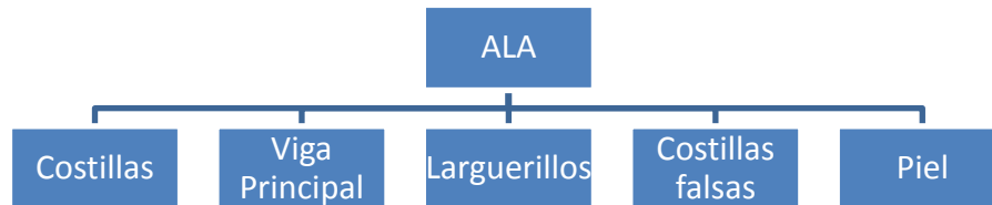
Figura: 8 Configuración estructural
