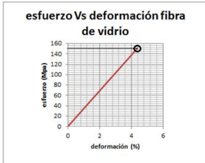
Figura 61 esfuerzo de falla seguro fibra de vidrio; fuente: autores
