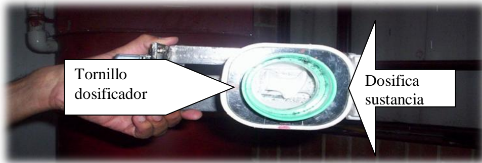
Figura1.9 Mecanismo de suministro de la sustancia solida.
