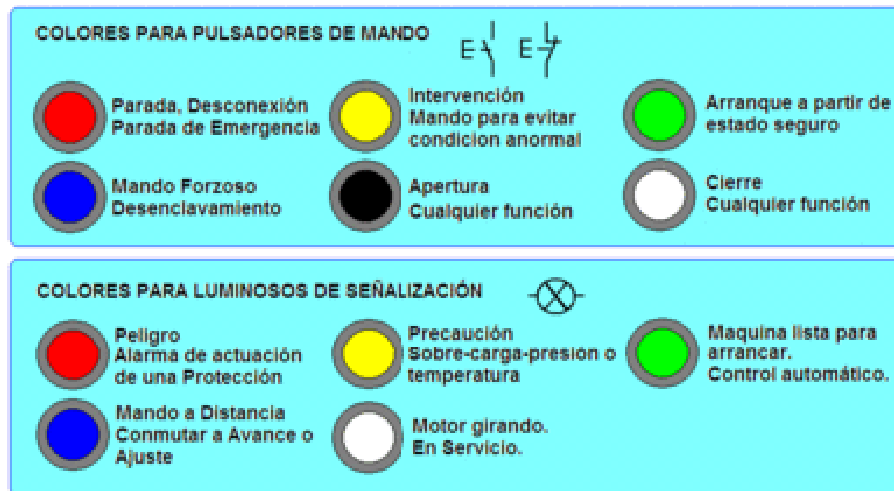
Figura 27. Señalización tableros de control
