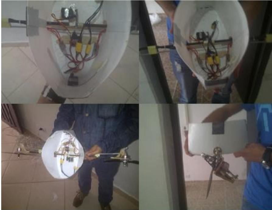
Figura 32. Ensamble final de la góndola.
