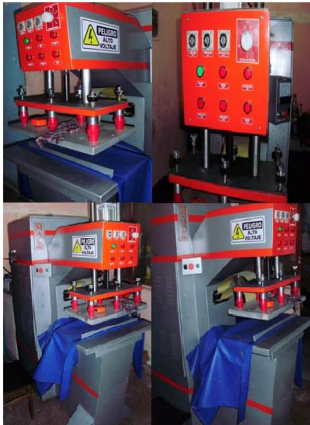
Figura 19. Máquina de sellado por electrofrecuencia
