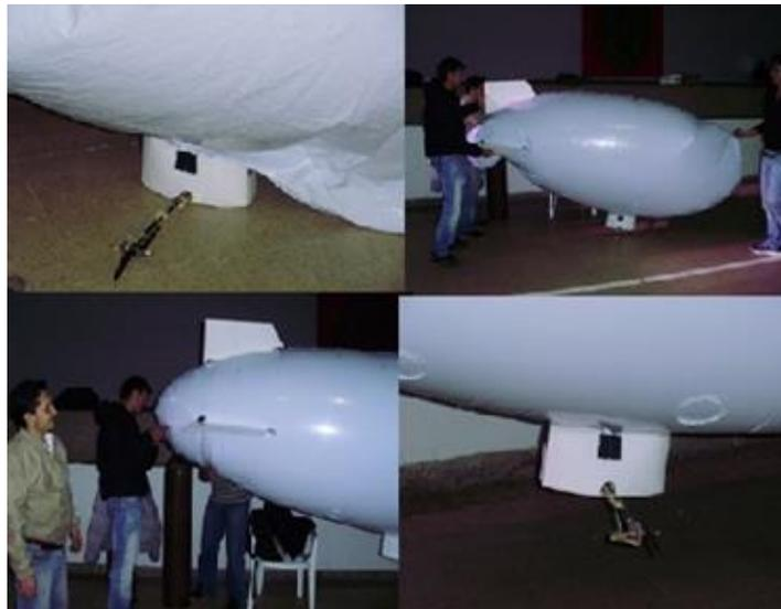
Figura 43. Ensamble de estabilizadores
