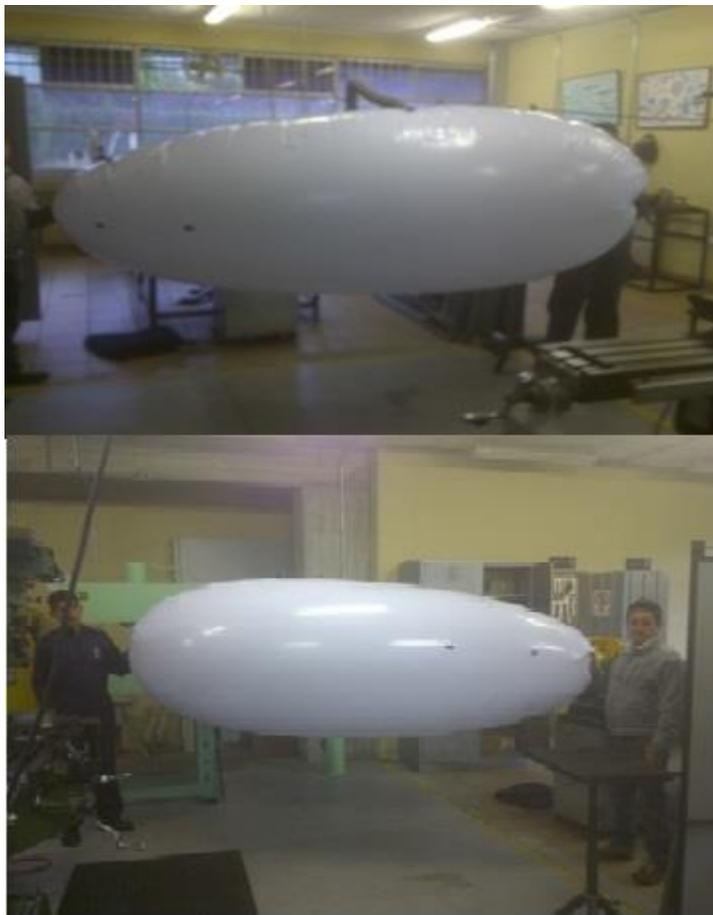
Figura 21. INFLADO CON AIRE A PRESIÓN
