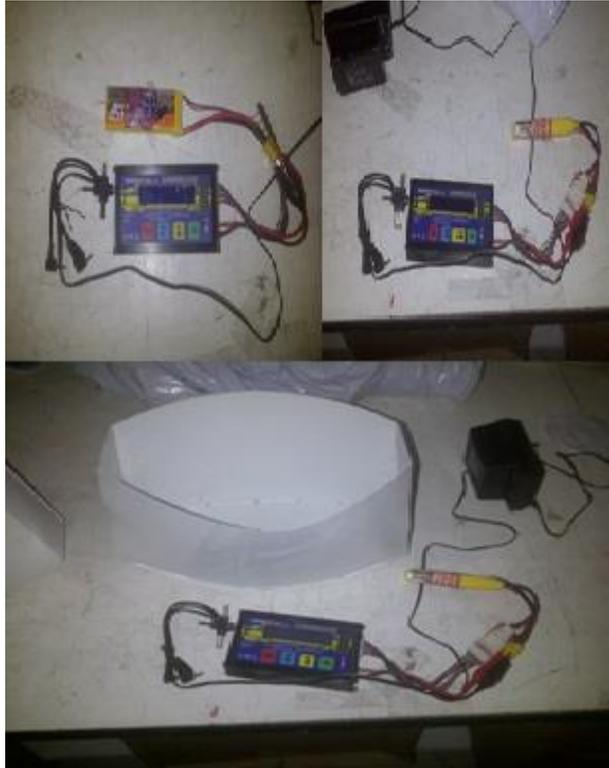
**Figura 25. Marca Rhino lipo de 2 celdas de 1550 Mah con su respectivo cargador.**
