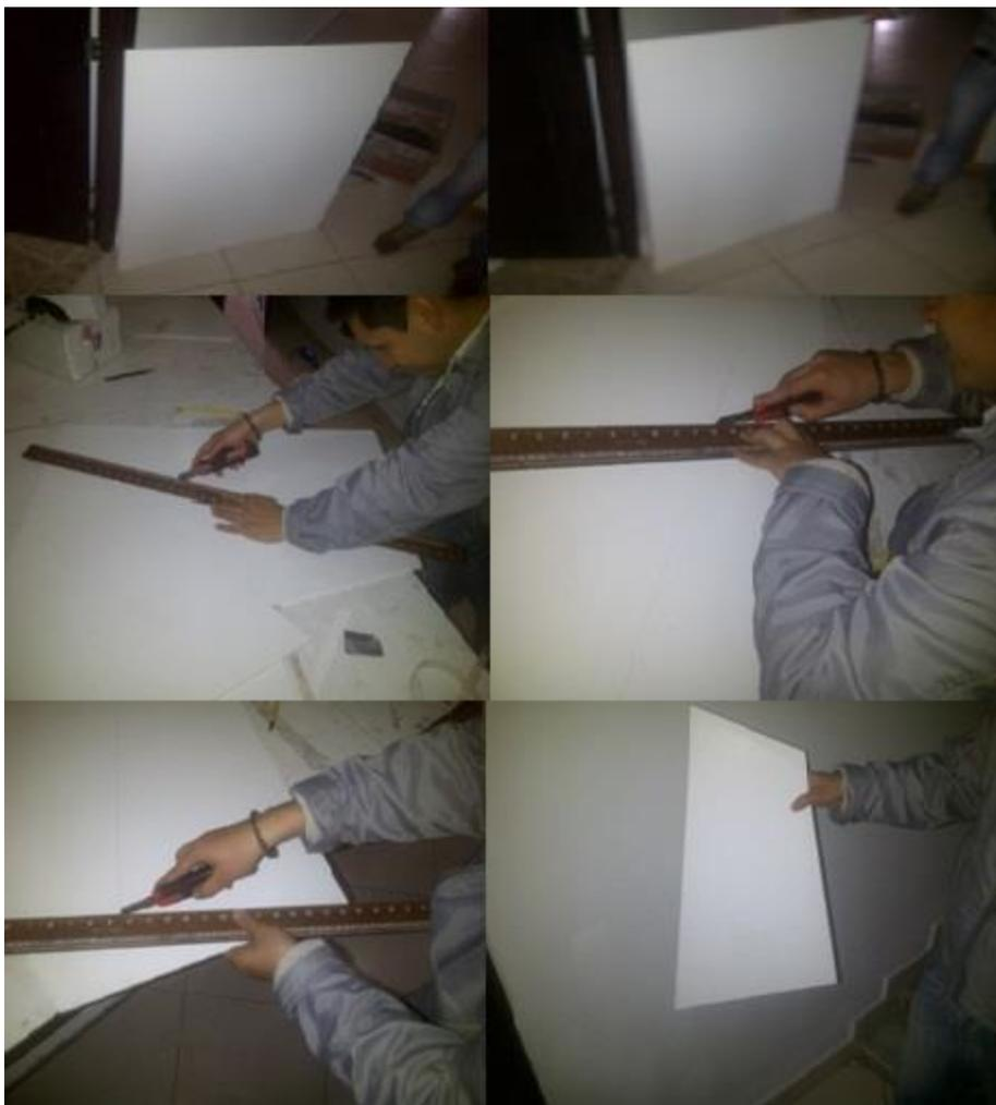
**Figura 22. Material a utilizar foam board y corte posterior corte de los estabilizadores.**
