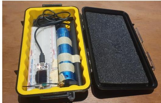
Fig. 19 Nodo Heltec ESP32 Wifi LoRaV2
