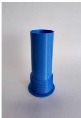
Pieza con tamaño inferior al necesario para el ensamble con el cohete USB Rocket I.
