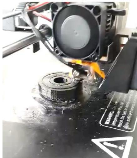
*Figura 13. Proceso de manufactura del grano ABS por medio de deposición fundida, fuente: Autor*
