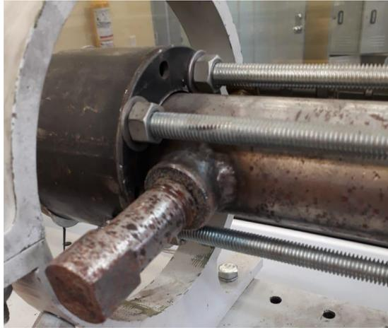
Figura 21. Precámara de combustión. fuente: Autor
