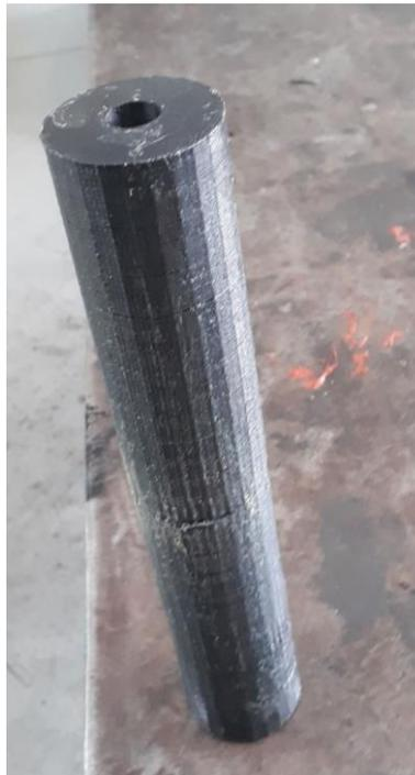
*Figura 14. Grano de ABS por medio de deposición fundida en su totalidad, Fuente: Autor*
