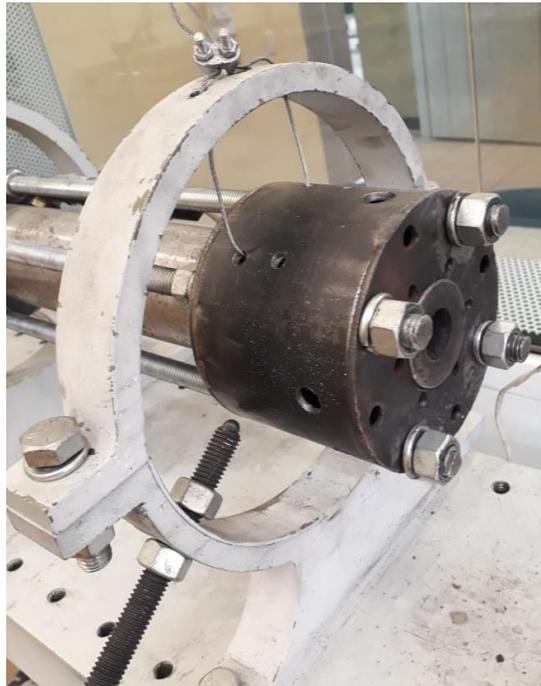
*Figura 24. Banco de pruebas con detalle en los soportes de un anillo de seguridad. Fuente: Autor*
