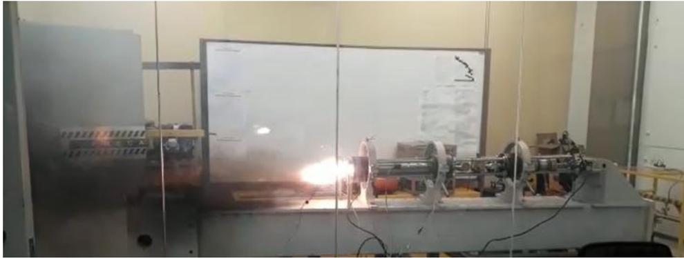
*Figura 25. Pruebas experimentales con el grano de ABS, fuente: Autor*
