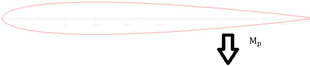
**Figura 41 Momento generado por el peso de la superficie**
