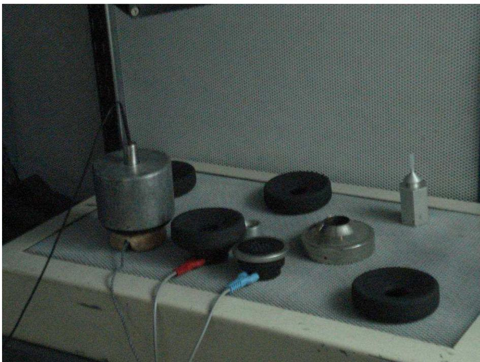
Figura N° 22. Sonda conectada a vibrador óseo
