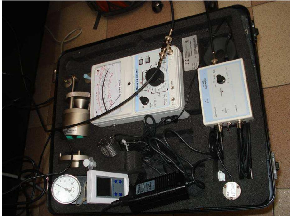
Figura Nº 16. Medidor HL con control y preamplificador
