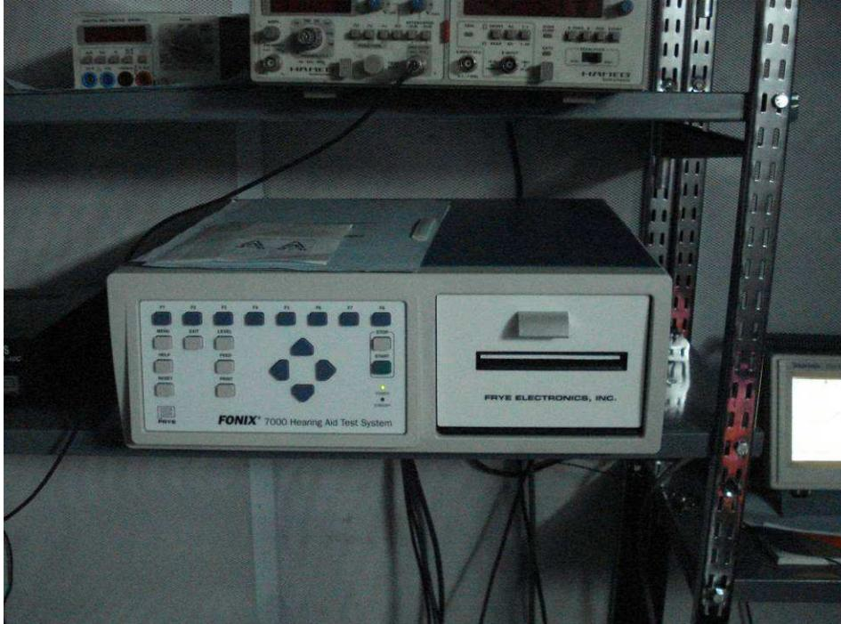
Figura N° 21. Sistema de prueba de audición FONIX 7000
