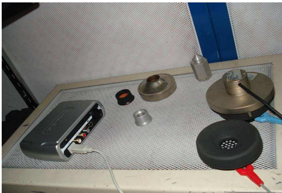
Figura N° 14. Tarjeta de Sonido MAudio Fast Track, Audífonos TDH 39
