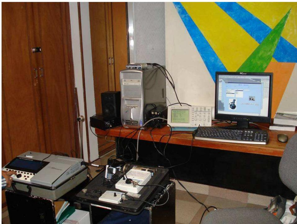
Figura N° 13. Conexión de Software de Audiometría a equipo de verificación
