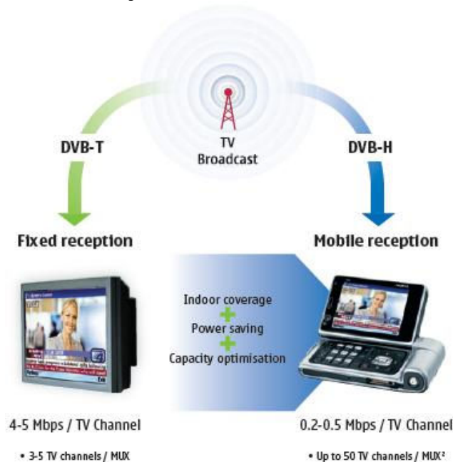
Figura 25. Recepción de TV fija vs. Móvil.
